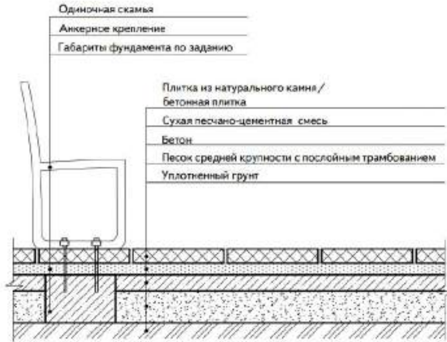
Илл. 5.1.1. ПРИНЦИПИАЛЬНАЯ СХЕМА МОНТАЖА СКАМЬИ В МОЩЕНИЕ
