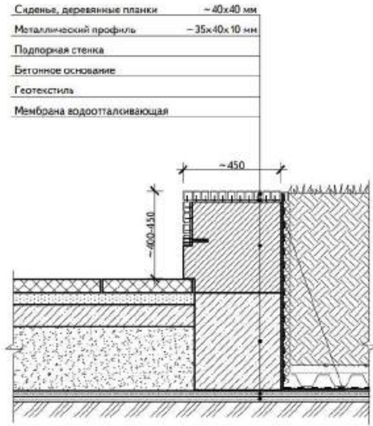
Илл. 5.1.3. Принципиальная схема устройства сиденья на подпорной стене
